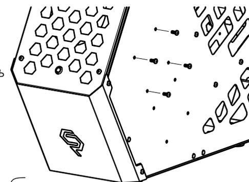
2. Закрепите 2,5" накопитель на специальной панели винтами из комплекта (Поз.6).
