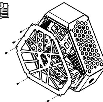
1. Для установки комплектующих открутите 8 винтов и снимите боковую крышку.
